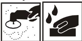
После отверждения краски, то есть через 4 часа при температуре +20°C можно полировать и устранять дефекты и включения абразивными материалами:
