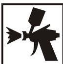
Наносить пульверизатором с соплом  $\varnothing 1,2 - \varnothing 1,5$  мм при давлении воздуха от 1,7 до 2,1 бар.
