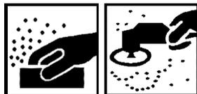
Осторожно удалить возможные очаги коррозии и шлифовать сухим способом наждачной бумагой P240-P320. Выровнять переходы к старому лакокрасочному покрытию и полиэфирным шпаклевкам.
