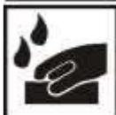
Поверхности, покрытые заводскими лаками и основами, шлифовать влажным методом с помощью наждачной бумаги P360-P400.
