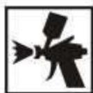
Наносить с помощью пистолета-распылителя, оборудованного соплом Ø1,8-Ø2,0 мм при давлении воздуха от 3,0 до 4,0 бар.
