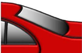
Отполируйте зону перехода ротационной полировальной машиной. Контролируйте давление полировальника на поверхность, а также направление вращения машины - из нанесенного ремонтного лака в зону перехода.
