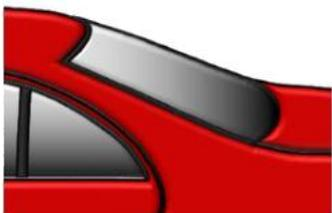
Отшлифовать участок под плавный переход и прилегающую зону окружающей поверхности с заходом на неповрежденное покрытие с помощью подходящего абразива, например, 3M Trizact P3000 Fine Finishing Disc.
