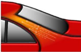
Смешать растворитель для переходов AK350 в пропорции 1:1 с готовой к нанесению 2К эмалью Cromax и нанести в течение 5 минут на зону перехода несколькими тонкими слоями на пониженном давлении. Выровнять зону перехода 2К эмали Cromax оставаясь внутри границ ранее подготовленной с помощью абразива P3000 поверхности.
